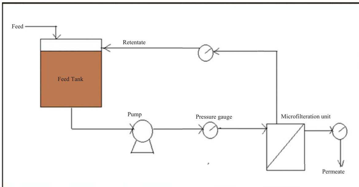
Fig. 1 : Microfiltration set up
